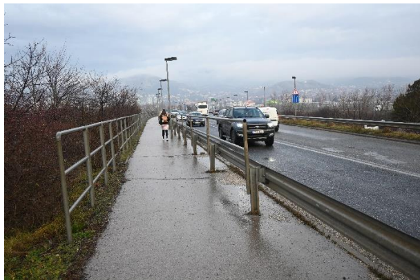
10. kép: Szűkületet okozó közvilágítási oszlopsor.
